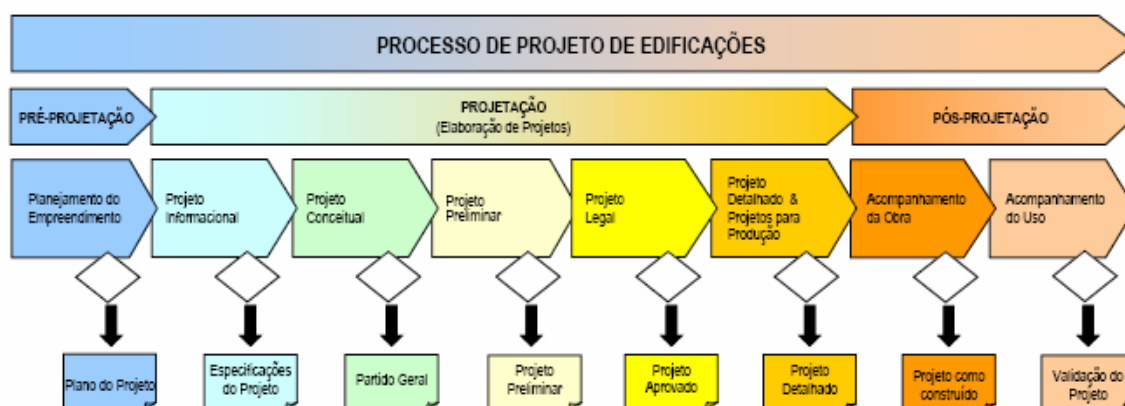
Figura 7 - Representação gráfica das fases do processo de projeto de edificações. Fonte: Romano (2003)
